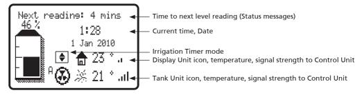
'Ĥ': Auto Mode 'M': Manual Mode : Pump On : Irrigation Timer mode off
